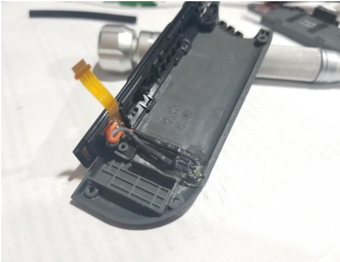
(Fig 24 - Sleidemekanismen på plass og bryter kombinert)
